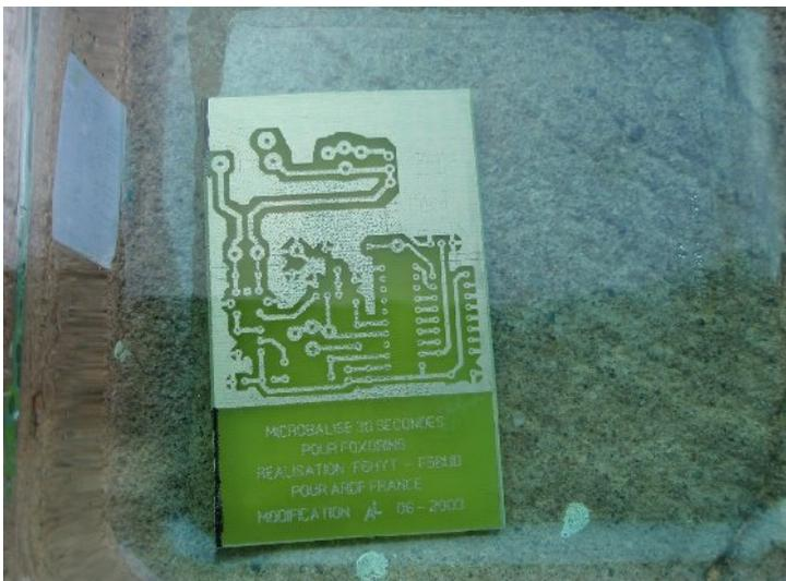
Au bout de quelques minutes, le cuivre a totalement disparu des endroits non protégés par la résine.
