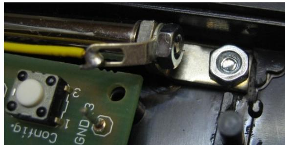
Bild 3: Montage des Eckwinkels bei 122 mm Teleskopantenne
